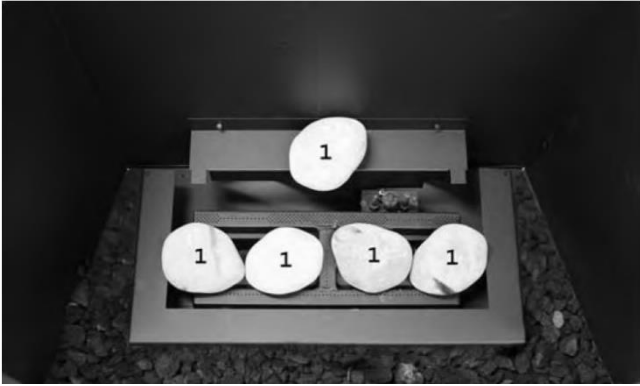
Étape 5 : Placez les pierres # 1 sur les brûleurs, tel qu'illustré. Ne pas placer de pierres directement sur les tubes du brûleur.
