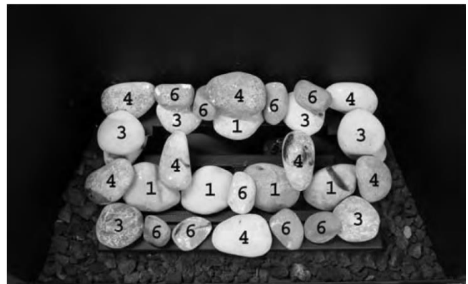
Disposition finale des pierres F3 Ne pas placer de pierres directement sur les tubes du brûleur.
