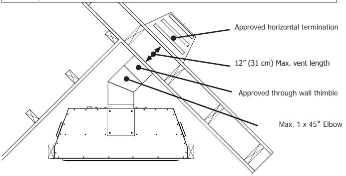
**Figure 35: Corner Vent Termination**
