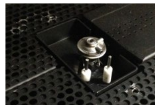
Figure 13. Retrait du couvercle de la veilleuse
