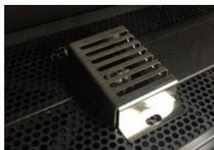
Figure 13. Retrait du couvercle de la veilleuse
