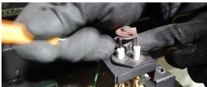
Figure 13.d Retirez l'attache à ressort
