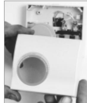
Mettre le couvercle sur le panneau de contrôle.
