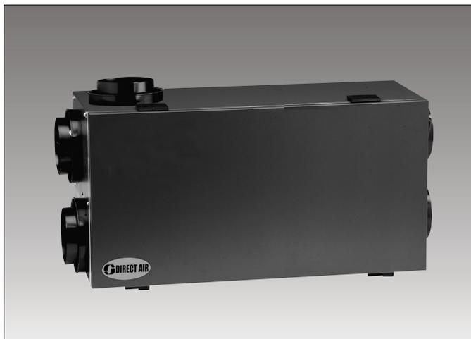
Nous vous présentons la série PHRVR 305 de ventilateurs-récupérateurs de chaleur (VRC) de Powrmatic. Tout comme dans le cas des modèles précédents, le flot d'air frais entrant est filtré avant d'être chauffé par l'air vicié sortant par l'intermédiaire d'un noyau récupérateur de chaleur en polypropylène. Le VRC répartit alors l'air filtré frais préchauffé dans la maison grâce au réseau de conduits solidaires de l'appareil ou au réseau de conduits d'un système à air pulsé.
