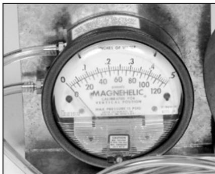
**2** Avant de prendre la lecture, assurez-vous que le manomètre Magnehelic est de niveau et indique 0. Consultez le tableau du poste de mesure pour déterminer le débit d'air de l'appareil.
