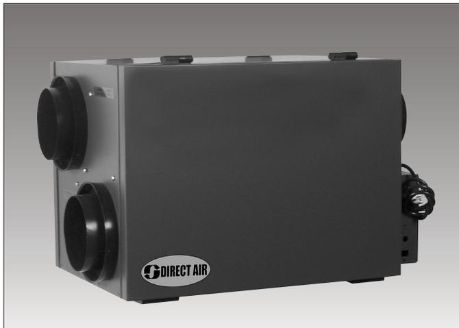
Nous vous présentons la NOUVELLE série PHRV de ventilateurs-récupérateurs de chaleur (VRC) de Powrmatic. Tout comme dans le cas des modèles précédents, le flot d'air frais entrant est filtré avant d'être chauffé par l'air vicié sortant par l'intermédiaire d'un noyau récupérateur de chaleur en polypropylène. Le VRC répartit alors l'air filtré frais préchauffé dans la maison grâce au réseau de conduits solidaires de l'appareil ou au réseau de conduits d'un système à air pulsé.
