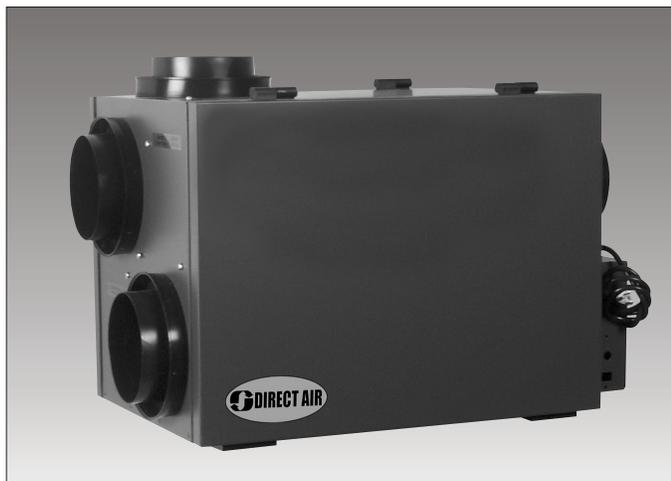
Nous vous présentons la NOUVELLE série PHRVR de ventilateurs-récupérateurs de chaleur (VRC) de Powrmatic. Tout comme dans le cas des modèles précédents, le flot d'air frais entrant est filtré avant d'être chauffé par l'air vicié sortant par l'intermédiaire d'un noyau récupérateur de chaleur en polypropylène. Le VRC répartit alors l'air filtré frais préchauffé dans la maison grâce au réseau de conduits solidaires de l'appareil ou au réseau de conduits d'un système à air pulsé.
