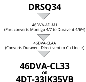
Figure 99.b Configuration ventilée arrière colinéaire.
