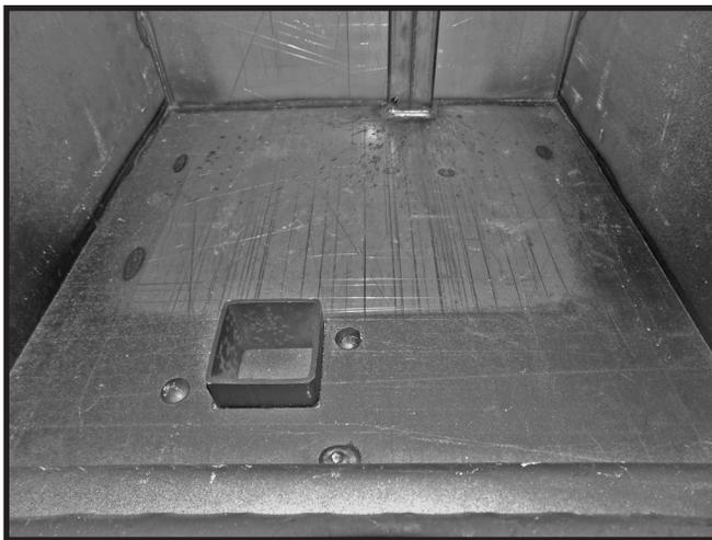
Figure 8: Plancher de la chambre de combustion et décharge de cendres.
