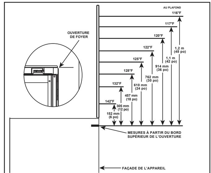
Figure 3.3 Températures de la surface du mur au-dessus de l'appareil
