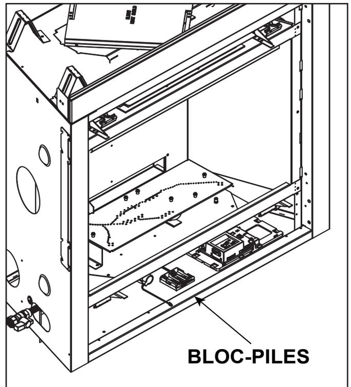
3.5 Bloc-piles situé dans la cavité des commandes
