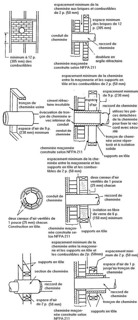
A. Maçonnerie en briques charpentée d'au moins 3,5 pouces (90 mm) d'épaisseur dans un mur inflammable avec une séparation en brique de 12 pouces (305 mm) minimum de la doublure en argile aux combustibles. La doublure en argile réfractaire doit aller de la surface de la sortie du mur en brique jusqu'à la surface interne de la doublure du tuyau de cheminée mais pas au delà et doit être solidement cimentée en place.
