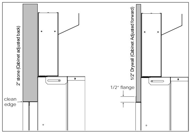
Figure 34: Finishing Edge Comparison
