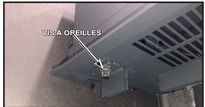
Figure 4.16 Démontage du panneau de verre et installation
