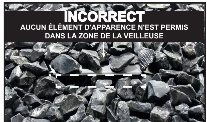
Figure 9.11 Disposition INCORRECTE de l'élément d'apparence
