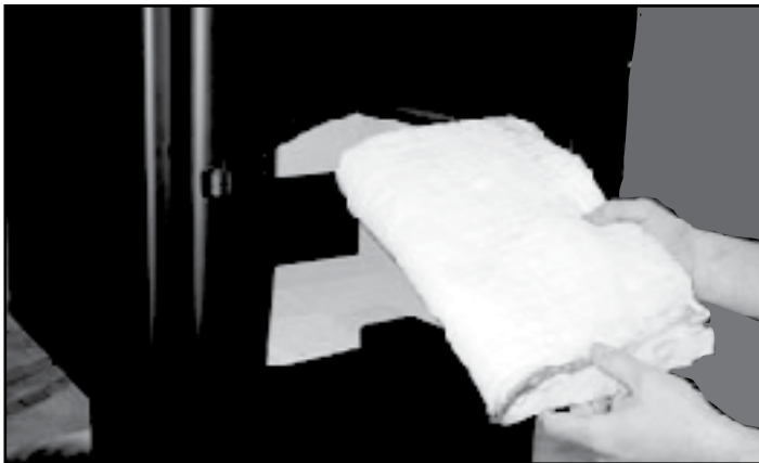
Figure 23.2 - Laine céramique isolante
