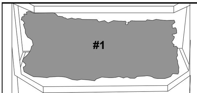
2. Placez la bûche de base #1 entre les supports à bûches, en vous assurant qu'elle repose contre l'arrière des supports.
