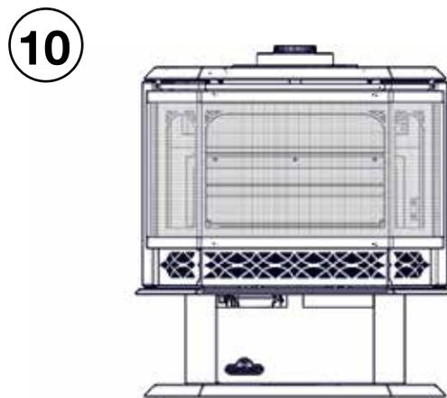
Lorsque vous ouvrez la porte vitrée, une simple procédure doit être suivie pour éviter d'endommager la porte. Ouvrez la porte de contrôle de la soupape, puis ouvrez complètement les deux portes latérales. Tirez les poignées vers vous et déclenchez chaque loquet. La porte peut maintenant être ouverte sans danger. Pour fermer la porte, répétez le procédé à l'inverse.
