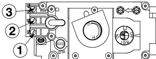
**GDS50-1 :** Débranchez les fils de l'interrupteur des bornes #1 et #3 et remplacez-les avec les fils de l'interrupteur mural/thermostat millivolt/récepteur.
