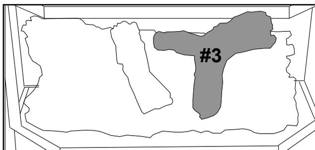
4. Alignez les tiges carrées de la bûche #3 sur les encoches du côté droit de la bûche de base.
