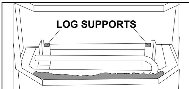
1. Placez les deux bandes de charbon de bois sur le bord avant de la chambre de combustion.
