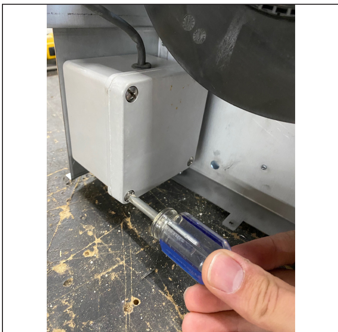
FIGURE 4.2 Retrait du couvercle du boîtier électrique
